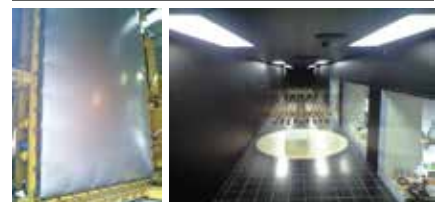
耐風圧性能試験・風洞試験
